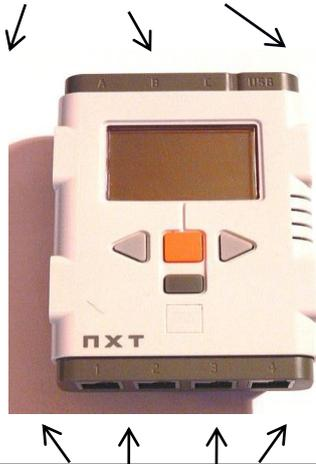
Порты для подключения датчиков 1, 2,
