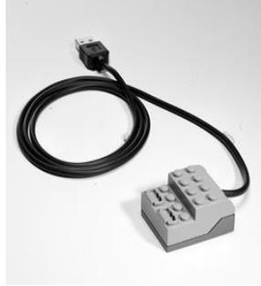
Кабель, идущий от мотора, подсоединим к USB ЛЕГО-коммутатору, который присоединим к USB компьютера с установленным программным обеспечением ПервоРобот LEGOWeDo.
